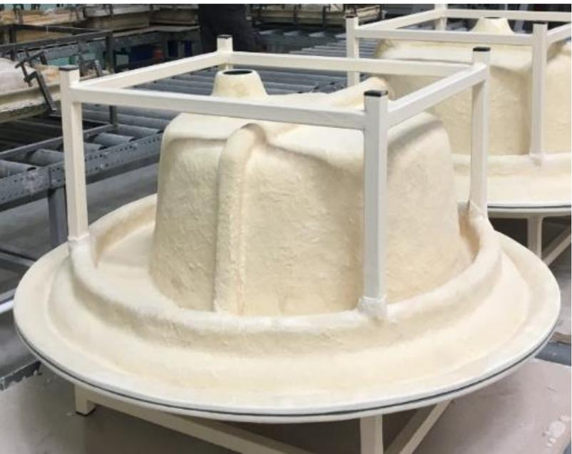
**Инжекционная заливка** (заливка под давлением) при производстве моек ULGRAN Quartz с использованием автоматизированных литьевых машин имеет ряд неоспоримых преимуществ перед ручной гравитационной заливкой:
